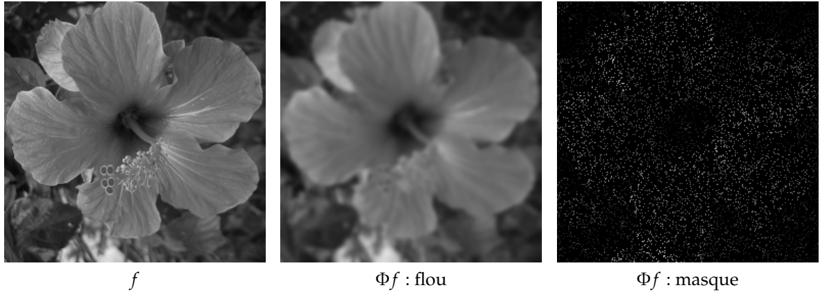
FIGURE 3.3. Deux opérateurs d'observation sans bruit appliqués à la même image de fleur : un flou gaussien et un masque conservant environ 10% des pixels. Les valeurs manquantes sont affichées en noir.
