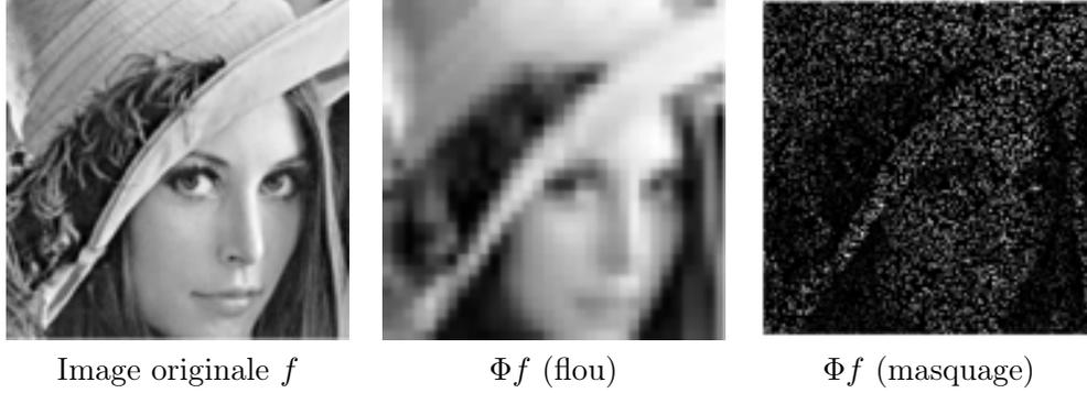
Figure 3.3: Observations (sans bruit,  $w = 0$ )  $y = \Phi f$  dans le cas de la convolution ( $\Phi f = \varphi \star f$  est une convolution par un filtre passe-bas  $\varphi$ ) et des données manquantes ( $\Phi = \text{diag}(\mu_q)_{q=1}^Q$  est un opérateur de masquage).
